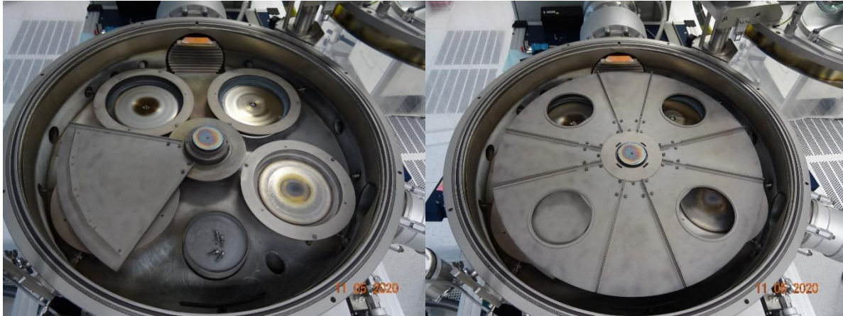
Abbildung 13: Innenraum der PZT Sputteranlage, der Kammerdeckel mit eingebautem Substratheizer ist seitlich weggeschwenkt. Links: Drehteller entfernt und Blick auf die Magnetrons und die rotierbaren Shutter. Rechts: Drehteller eingebaut
