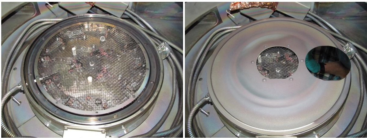
Abbildung 1: Strahlungsheizer ohne (links) und mit Substrat Carrier (rechts, mit daneben liegendem 4" Si-Wafer zur Veranschaulichung)
