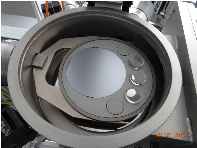
Abbildung 15: Neu gefertigter Mo-Probenhalter bestückt mit 4" Si-Wafer und 1" Glassubstraten in der Vakuumschleuse der PZT-Beschichtungsanlage.
