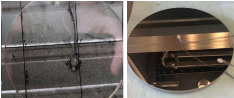
Abbildung 38: Metallisierungsschichten des FEP auf ULE nach 700°C Heizungstests durch Projektpartner scia (mit noch aufgeklebten Thermoelementen zur Temperaturmonitorierung); links: erste Iteration (Schichtablösung), rechts: finale Iteration (keine Schichtablösung)
