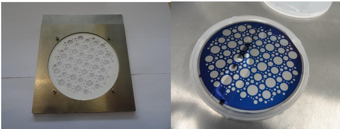
Abbildung 21: Links: Proben- & Maskenhalter für NiCr Bedampfung mit eingelegter Schattenmaske. Rechts: NiCr Top-Elektroden auf 4" Wafer hergestellt mit Schattenmaske.
