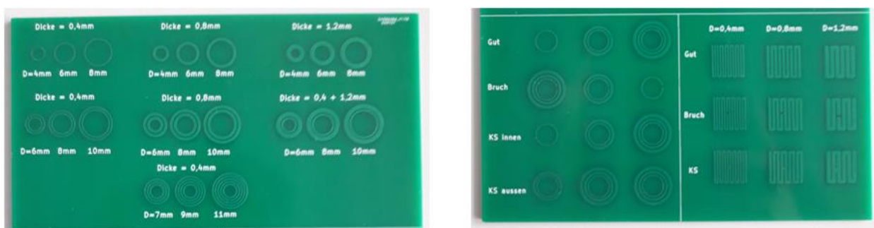
Abbildung 7 - Beispiellayout von Teststrukturen auf Leiterplattenbasis
