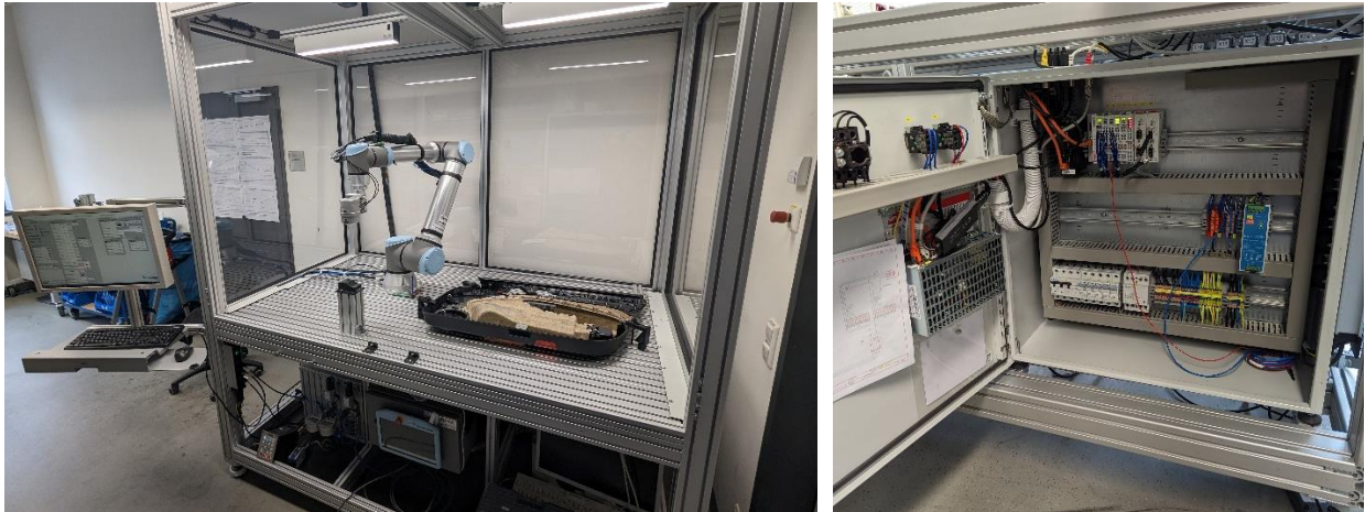
Abbildung 9 - Roboterzelle (links) und Schaltschrank mit Industrie-PC 6015 Beckhoff (rechts)
