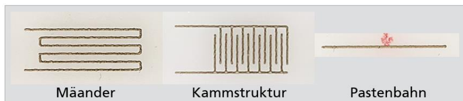
Abbildung 6 - Konzept von Prüfstrukturen
