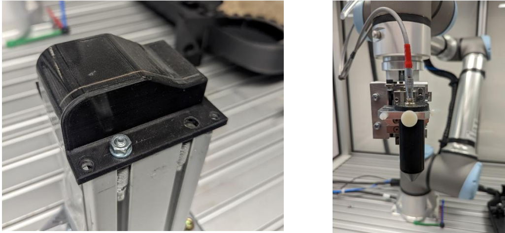
Abbildung 11 - 3D-Beispielkörper mit gedruckter Leiterbahn (links) und WS Sensor auf dem Roboter (rechts)
