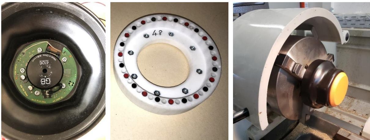
Abbildung 24: Achskapselsensor, links: Sensorplatte mit Generator, mitte: Magnetscheibe zur Drehzahlerfassung, rechts: Test auf der Drehbank
