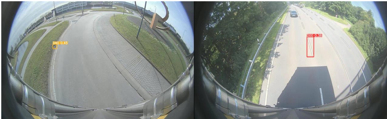
Abbildung 78: Fehldetektionen bei Überlandfahrten. Oben: Fehlerhafte Detektion eines Schlaglochs an der Stelle eines Straßenablaufs im Bordstein. Unten: Falsch-positive Detektion einer Fahrbahnmarkierung als Längsriss.
