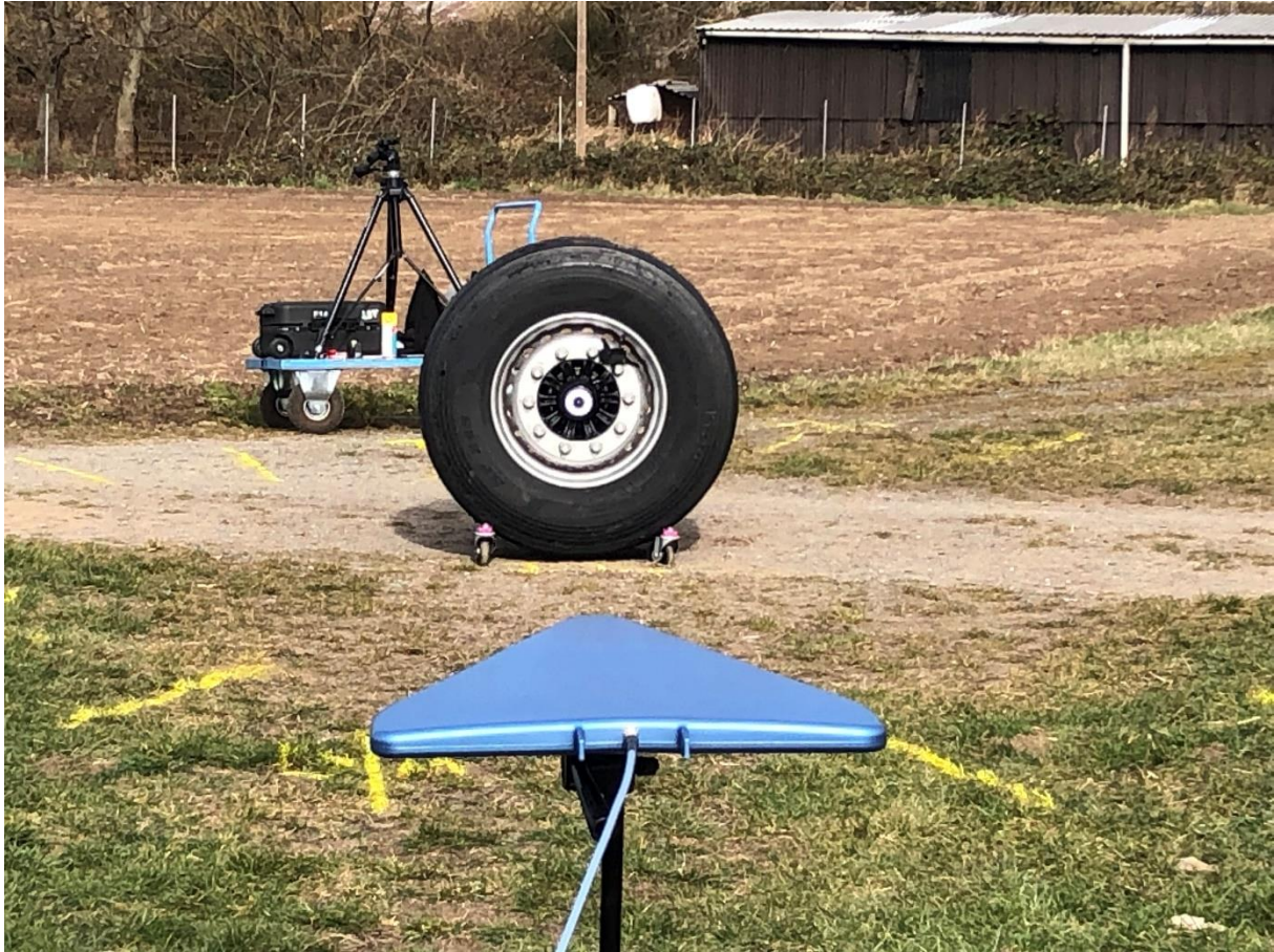
Abbildung 12: Funkfeldvermessung des Achskapselsensors im Freifeld
