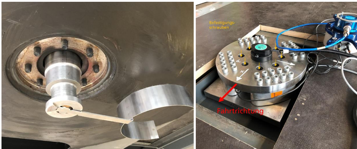
Abbildung 103: KingPin Messplattform im IdenT-Trailer
