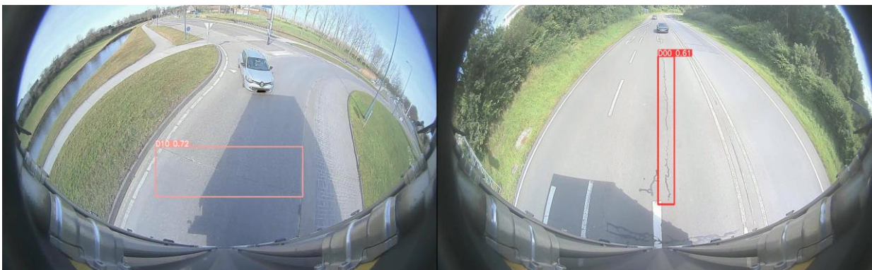
Abbildung 77: Erfolgreiche Detektionen von Fahrbahnschäden auf Überlandfahrten. Oben: Detektion eines Querrisses, Unten: Detektion eines ausgebeisserten Längsrisses.
