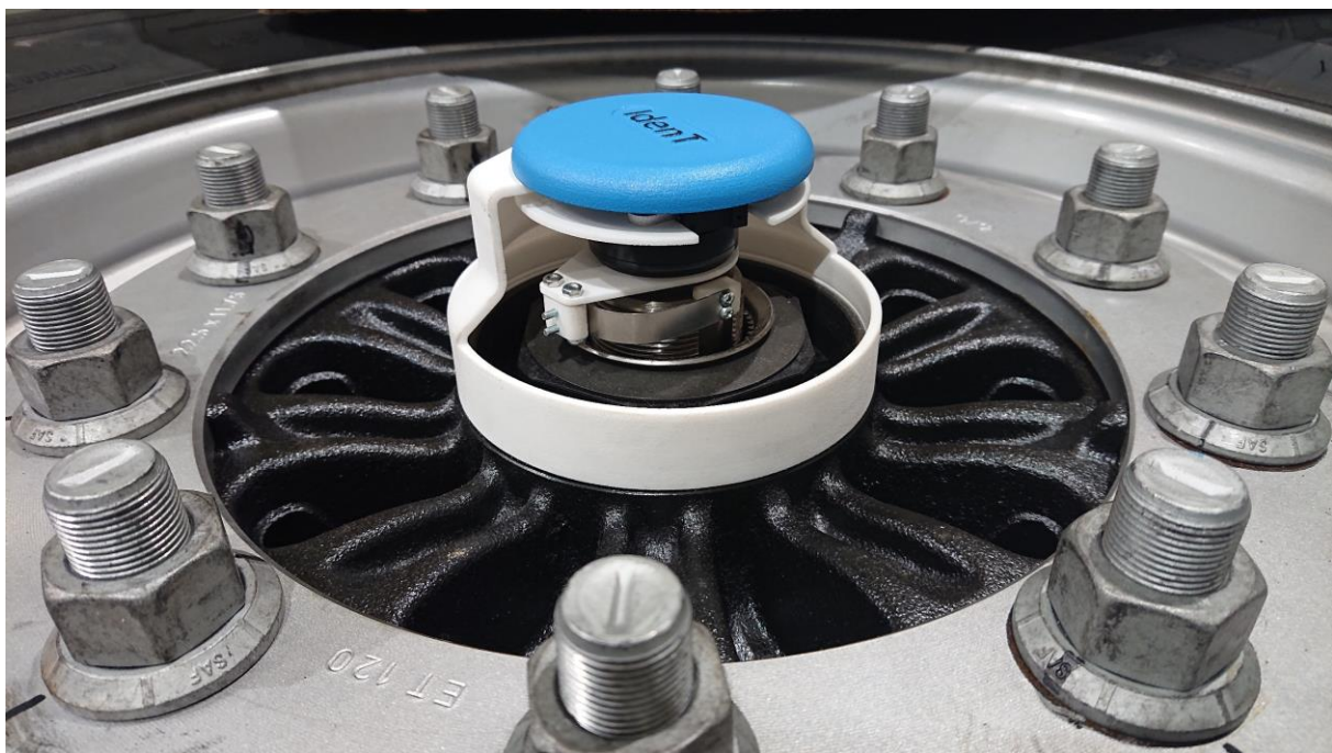
Abbildung 21: Schnittmodell des Achskapselsensors zur Untersuchung der Montagemöglichkeit
