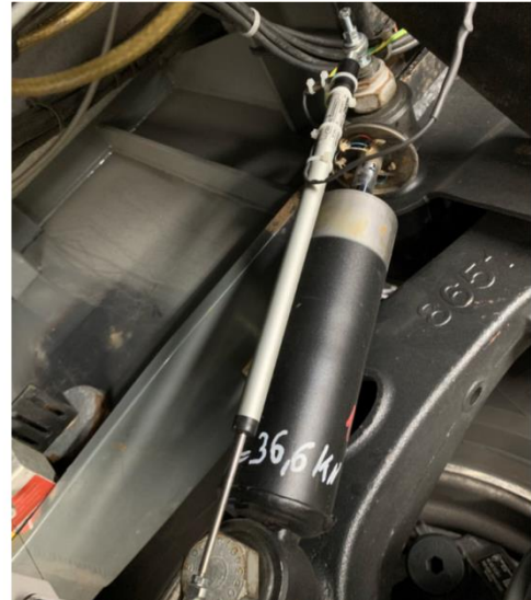
Abbildung 109: Gezielt eingebrachter Lagerschaden am Außenring (links) und gezielt eingebrachte Undichtigkeit am Stoßdämpfer inklusive Kraft- und Wegmessung
