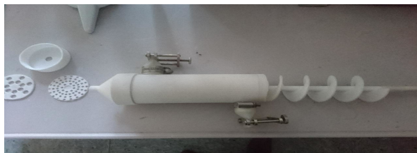
Abb. 2: 3-D Druck Kolbenpressschnecke mit austauschbaren Sieblochplatten.
