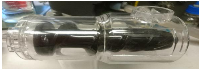
Abb. 4e: Alternative ohne Lochsieb – Dünnschlammabtrennung in einem Spalt zwischen Pressschnecke und Einhausung.
