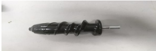
Abb. 4f: Variable Gewindemaße zur Unterstützung der Separation von Dünnschlamm.
