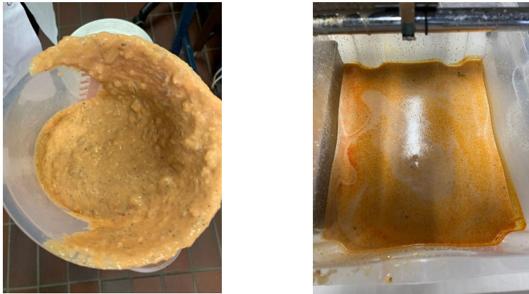
Abb. 7: links - Kulturbrühe aus Küchenresten mit einem Trockensubstanzgehalt von 23% (w/w); rechts - Filtrat nach Anwendung in der Pressschnecke.
