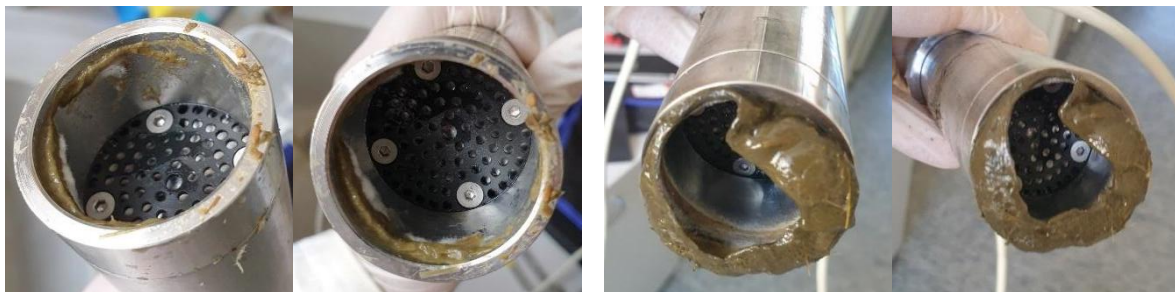
Abb. 24: Biofilmbildung an den Extraktionskammern der Messsysteme nach 2 wöchiger Messung in der hydrolytischen (links) und methanogenen (rechts) Prozessstufe.
