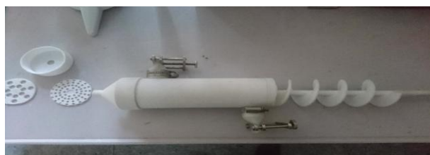
Abb. 4b: Pressschnecke für die Dünnschlammrezirkulation im Labormaßstab zum Test verschiedener Sieblochplatten.
