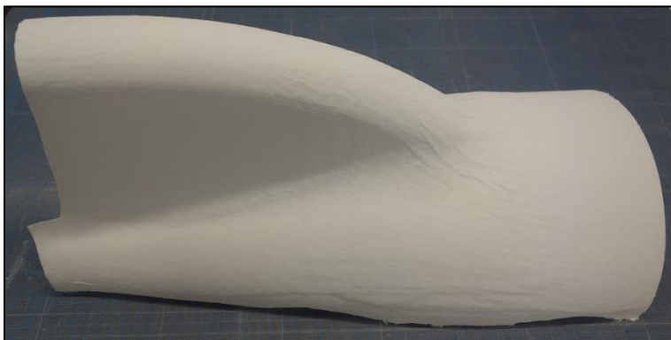
Abbildung 6: Unbearbeitetes Long Lobe nach dem Sinterprozess.
