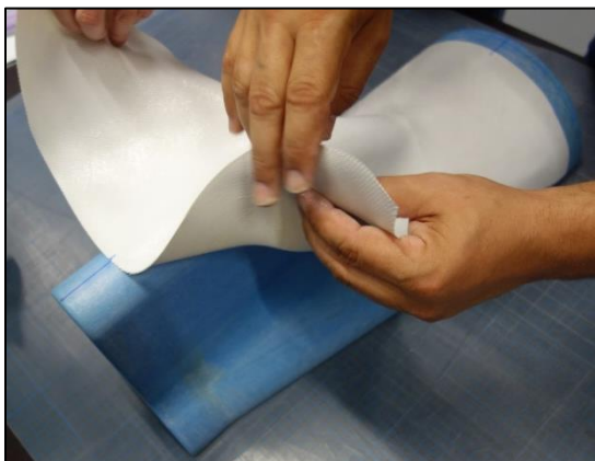
Abbildung 3: Ablage der 1. Gewebelage auf die Form des Long Lobes.
