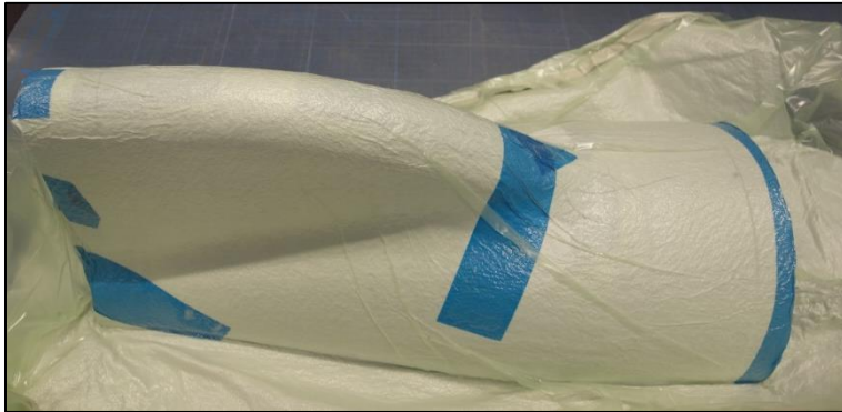
Abbildung 5: Long Lobe eingepackt im Vakuumsack nach der Verdichtung im Autoklav.
