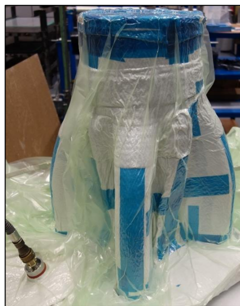
Abbildung 9: Aufnahme während dem Laminierprozess des 4 Lobes (links) und im Vakuumsack (rechts).
