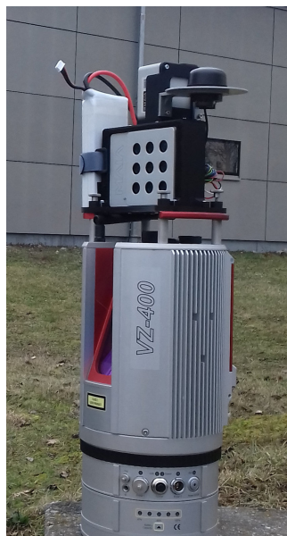
Abbildung 2.2: Bodensegment. Die auf dem Laserscanner montierte Multispektralkamera dient zur Erzeugung multimodaler Punktwolken
