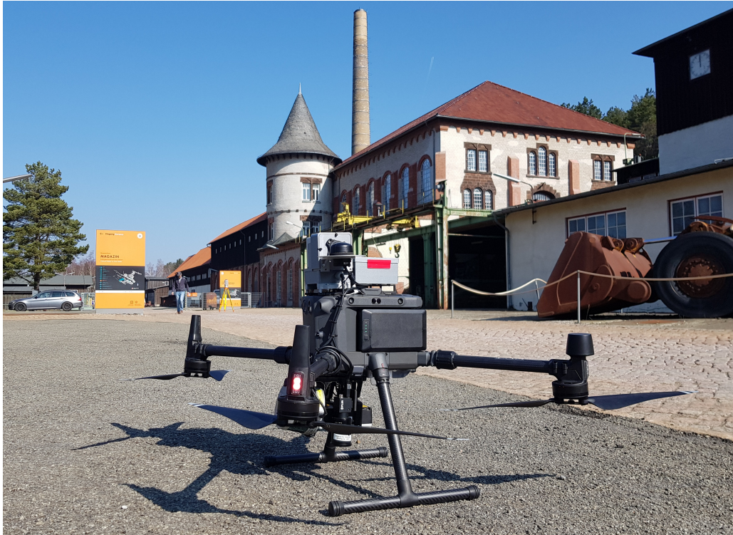
Abbildung 2.1: UAV mit montiertem Sensormodul, bestehend aus Laserscanner und Multispektralkamera
