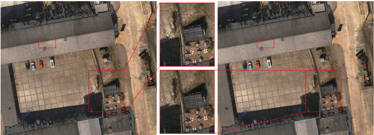
Abbildung 2.8: Ausschnitt aus der Punktwolke vor (links) und nach (rechts) der radiometrischen Optimierung auf dem Gesamtdatensatz des Erzbergwerk Rammelsberg. Hervorgehobene Bereiche zeigen Verbesserungen in den Farbverläufen
