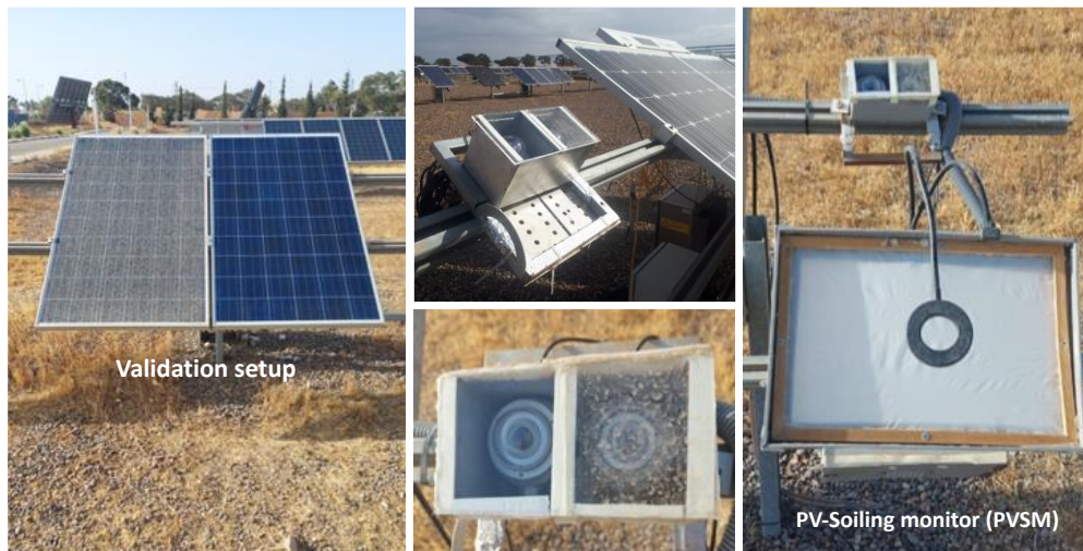
Abbildung 3: Experimentelles Setup PVSM, installiert in Marokko, Ben Guerir
