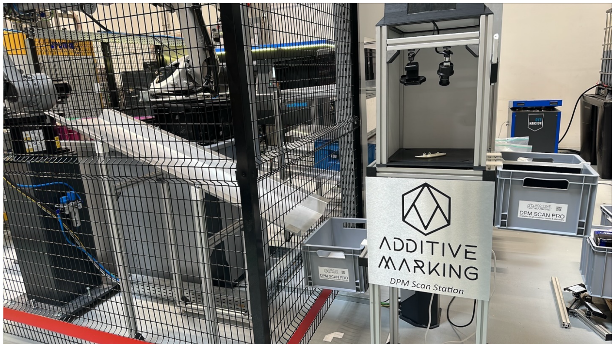
Abbildung 10: Aufgebaute Rutsche mit Ausschleusung und Additive Marking Scanbox zur Stichprobenprüfung
