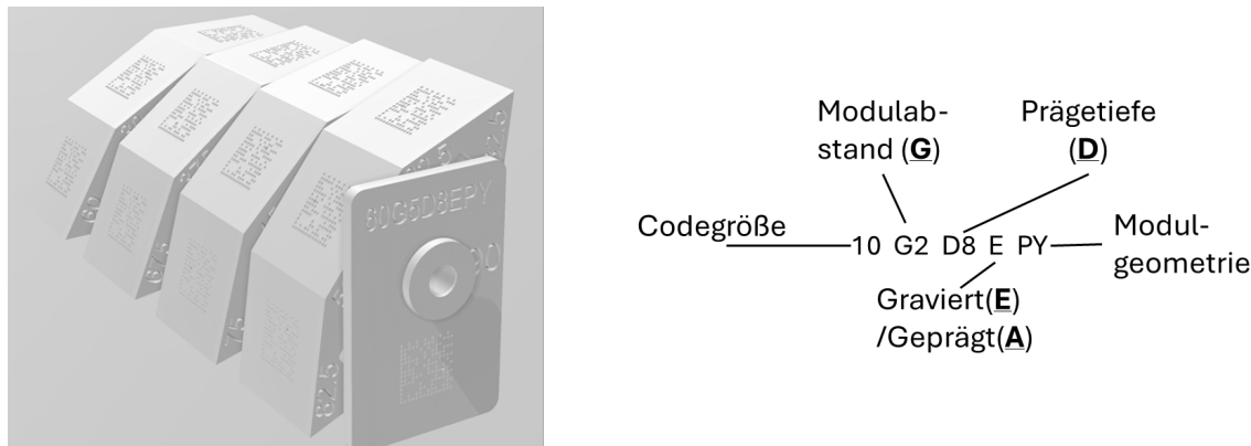
Abbildung 6: Weiterentwickelte Prüfkörper mit größerer Anzahl an Testmarkierungen (links) und die Codierungsvorschrift der Markierungen (rechts)
