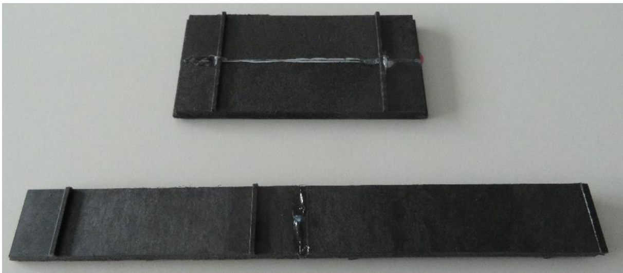
Abbildung 15: Probekörper gefügt mittels Cyanacrylatklebstoff
