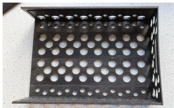
Abbildung 26: Ergebnis der gefügten Demonstratorschublade.
