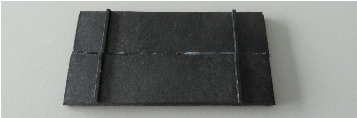
Abbildung 17: Probekörper gefügt mittels Schmelzklebstoff
