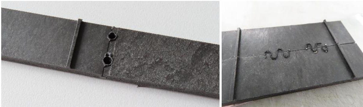
Abbildung 14: Probekörper gefügt durch Kunststoffschweißen.
