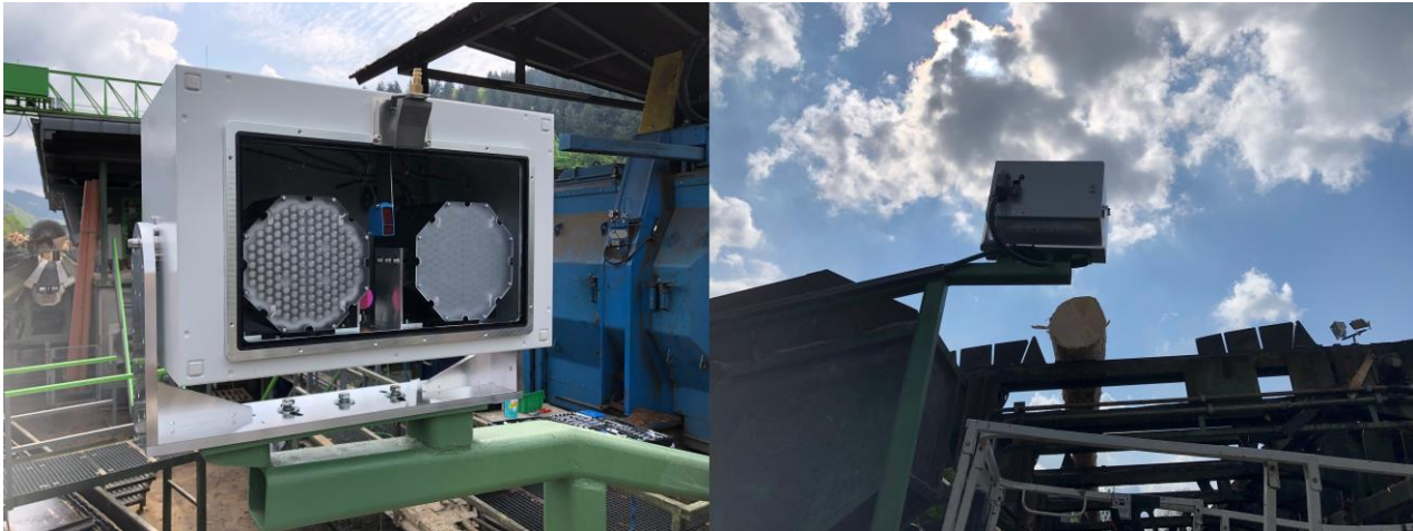
Abbildung 4: Das Lesesystem an der zweiten Position im Sägewerk nach der Kappsäge. Links die Vorderseite des Aufbaus. Zu sehen sind zwei LED-Blitzer und das Objektiv der Kamera. Rechts die Rückseite des Aufbaus.
