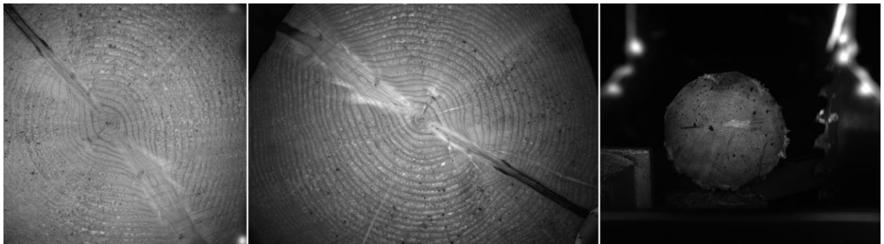
Abbildung 6: Exemplarische Aufnahmen derselben Baumstamm-Stirnfläche im Vergleich der drei Lesesysteme. Von links nach rechts: Vollernter (Pixelauflösung 110 \mu\text{m} ), Polter (123 \mu\text{m} ), Sägewerk (158 \mu\text{m} ).
