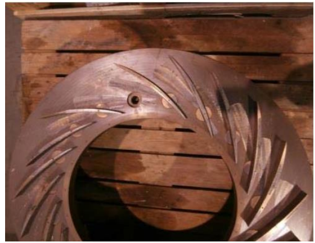
Abb. 4: Fotos zum Nachleitgitter [Quelle: MAN ES]; links: Hinterseite der Radialverdichterstufe mit montierten Stellmotoren, rechts: demontiertes Nachleitgitter
