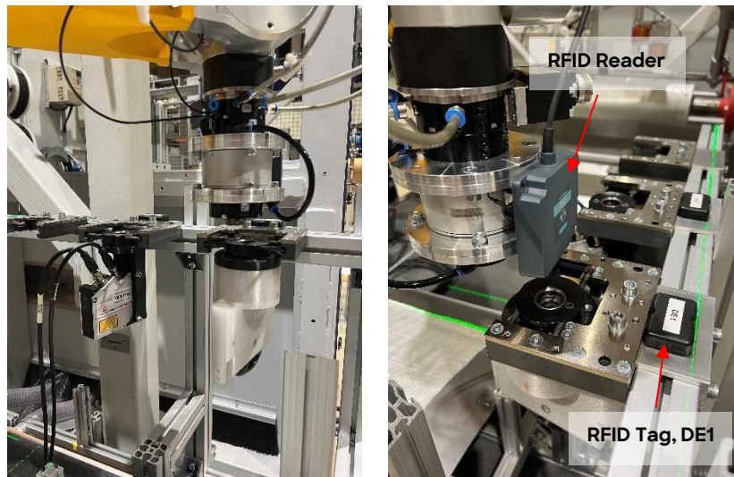
Abbildung 24: Ablagestation mit Linienlaser und Drapiereinheit und Auslesen des RFID-Tags der Drapiereinheit
