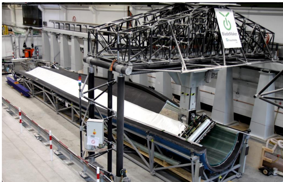
Abbildung 1: Automatisierter Ablage- und Drapierprozess (DTP-Prozess) eines Glasfasergeleges im BladeMaker-Demozentrum in Bremerhaven
