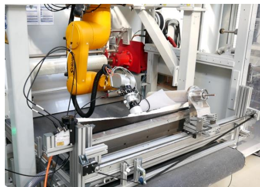
Abbildung 18: Automatisierter Drapierprozess mit Ablage des Zuschnittes mit Hilfe der Wickelwelle
