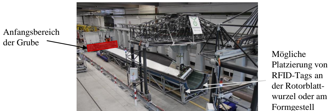
Abbildung 26: Integration von RFID-Technik im BladeMaker-Demozentrum am IWES. Im Anfangsbereich der Grube können aufgewickelte Zuschnitte und zusätzliche Einheiten, wie z.B. eine weitere Drapiereinheit, aufgenommen werden.
