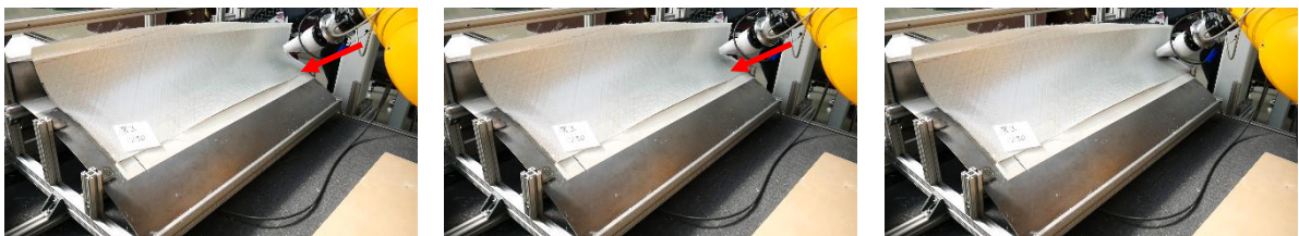
Abbildung 10: Einfahren der Drapiereinheit (der rote Pfeil zeigt die Bewegungsrichtung an)
