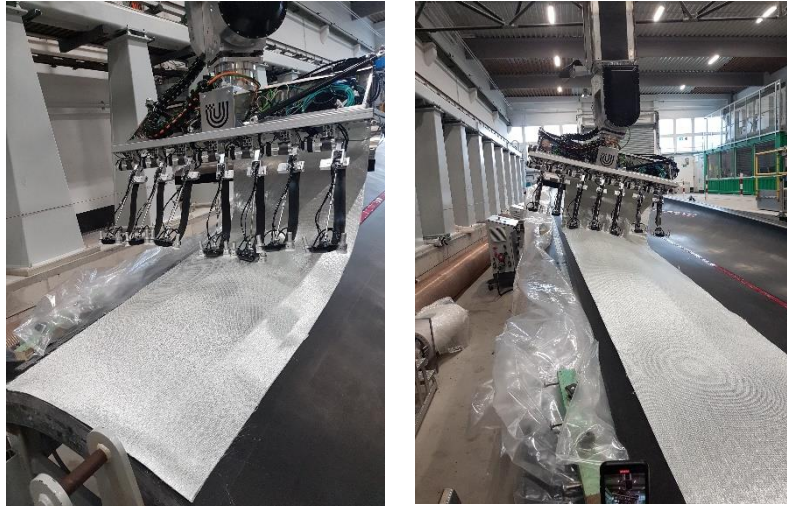
Abbildung 21: Ablage des Zuschnittes an der Außenkante des Rotorblattformwerkzeuges
