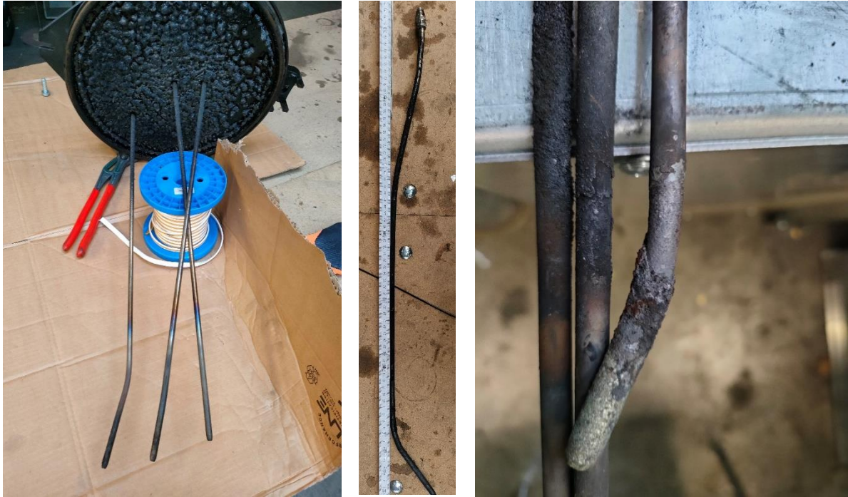
Abbildung 16 Temperaturmesslanzen bei der Überprüfung aufgrund von Störungen während der Messkampagne; Deckel mit drei Lanzen zum Teil stark verschoben (links); verbogene Lanze mit Gliedmaßenstab als Bezugsgröße (mittig); abgeknickte Lanze mit deutlichem Materialverlust am Mantel (rechts).
