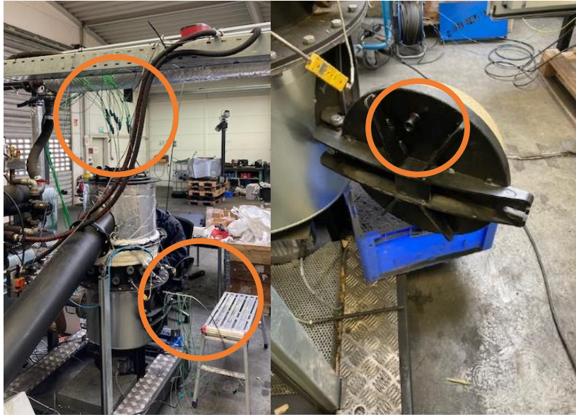
Abbildung 25 Lanzenzugänge am Reformer – Von oben und von der Seite durch den Seitendeckel im Reduktionsbereich unterhalb der Oxidationszone.
