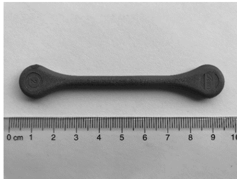
Abbildung 4: Mittels MIM-hergestellte Knochenprobe
