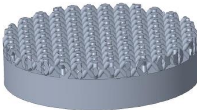
Abbildung 16: Probekörper für Toxizität-Untersuchungen mit einlagiger kfz-Gitterstruktur
