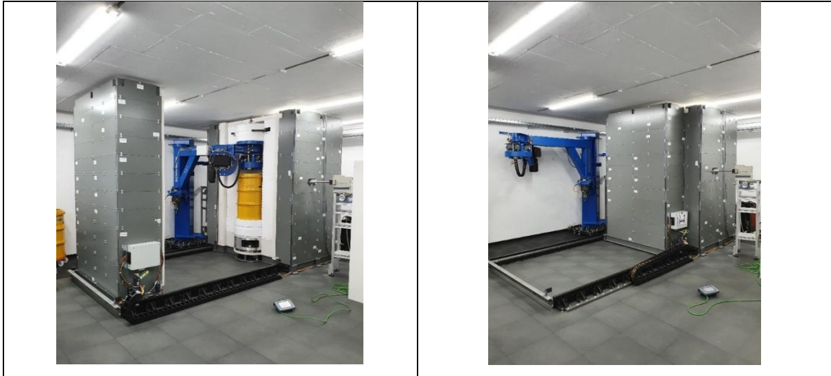
Abbildung 34: Übersicht der stationären Messanlage QUANTOM im geöffneten Zustand (links) und geschlossenen Zustand (rechts)
