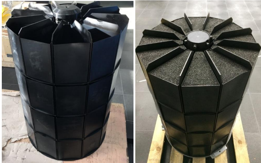
Abbildung 46: Skelett mit 48 Partitionen für die Demonstrierung der inhomogenen Materialverteilung. Links: das leere Skelett ohne Befüllung. Rechts: Skelett mit Asilikos homogen befüllt.
