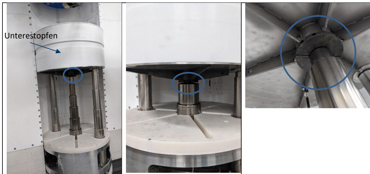
Abbildung 6: Anbringen einer Klemme (Anti-Verkippungssystem in blau auf den Bildern eingekreist) unter dem Zirkonium Teller.
