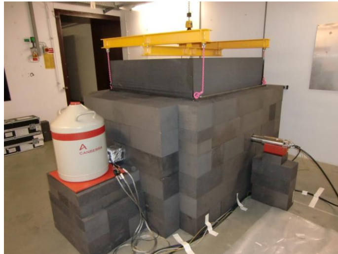
Abbildung 2: MEDINA-Messanlage zur stofflichen Charakterisierung von radioaktiven Abfällen verpackt in 200-l-Fässern (Bildquelle Forschungszentrum Jülich GmbH).
