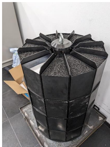
Abbildung 5: Instrumentierungsfass bestehend aus 48 Sektoren.
