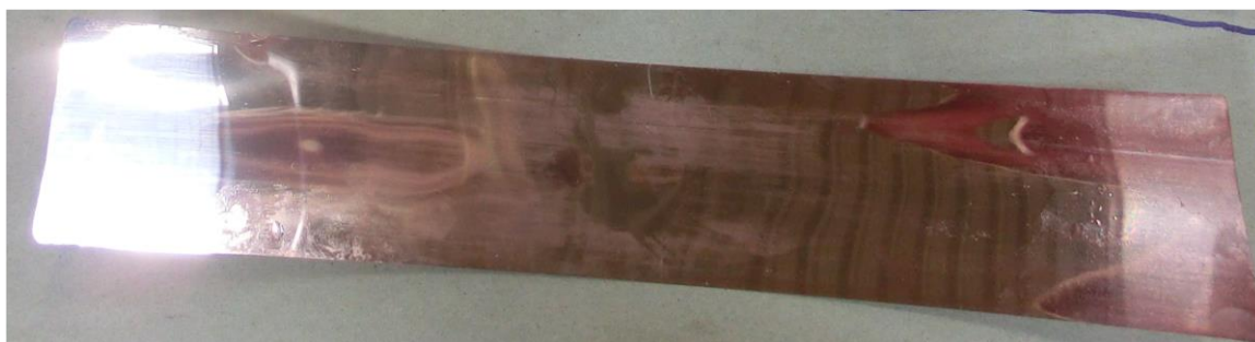
Abbildung 10: Blech gewalzt ohne Zwischenglühung.
