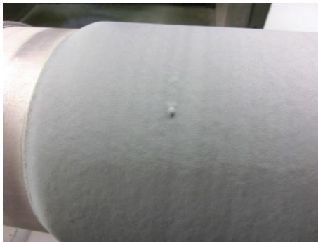
Abbildung 4: links) Rotzer auf Targetschicht rechts) Loch in Schicht nach Reinigung der Oberfläche
