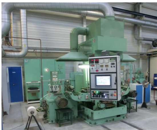
Abbildung 9: Reversierendes Quarto- Walzwerk der GfE- Fremat.
