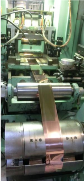
Abbildung 12: Reversierendes Walzen einer 1m- Probe unter Zug auf dem reversierenden Quarto- Walzwerk der GfE- Fremat.
