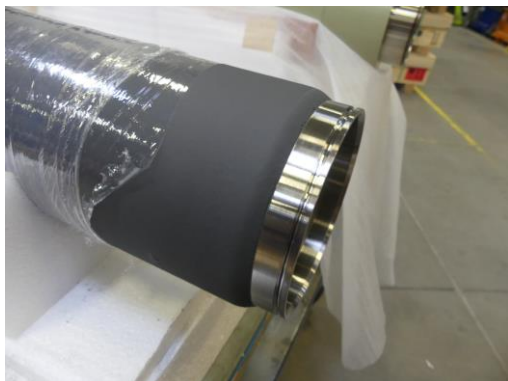
Abbildung 6: Targetmuster \varnothing 142 mm x 950 mm, Meilenstein 3.1
