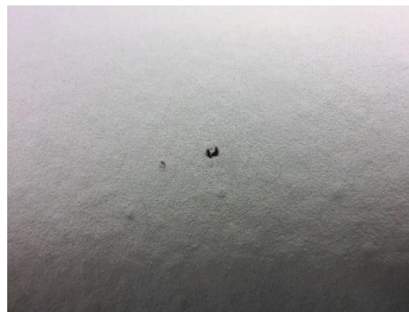
Abbildung 4: links) Rotzer auf Targetschicht rechts) Loch in Schicht nach Reinigung der Oberfläche
