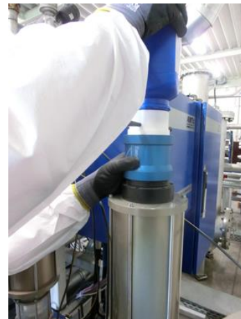
Abbildung 3: a) persönliche Schutzausrüstung, b) Box zum staubfreien Umfüllen von NiO Pulver, c) Befüllen von Pulvertöpfen mit Easy Fill
