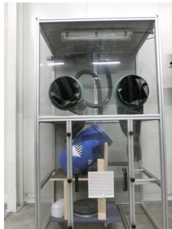
Abbildung 3: a) persönliche Schutzausrüstung, b) Box zum staubfreien Umfüllen von NiO Pulver, c) Befüllen von Pulvertöpfen mit Easy Fill
