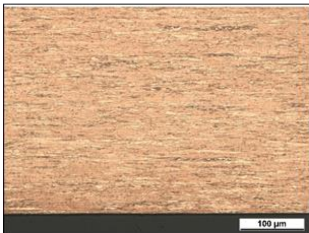
Abbildung 7: Band mit Dicke 0,6mm im Anlieferungszustand. Der geätzte Zustand zeigt ein typisches Verformungsgefüge.
