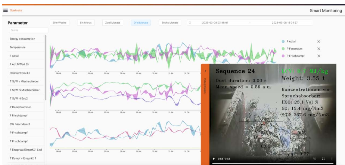
Abbildung 55: Beispiel für eine Visualisierung der Messwerte mit Zuordnung der verarbeiteten Videosequenzen im Smart Monitoring Tool von INCTEC (Abbildung von Incontext Technology INCTEC)
