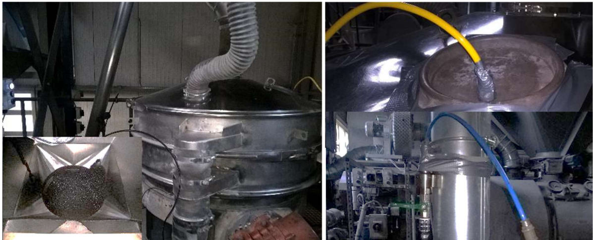
Abbildung 22: Probenahme Staubkonzentration im Inneren der Schneidmühle
