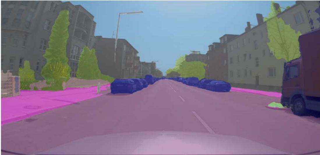
Abbildung 3: Beispiel für semantische Segmentierung mit Mask R-CNN
