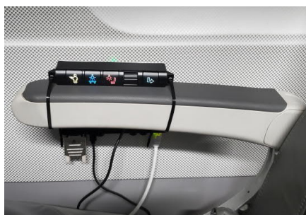
Abbildung 15: Tastenfeld am Sitz (links) zum Steuern von Benachrichtigungslampen (rechts)
