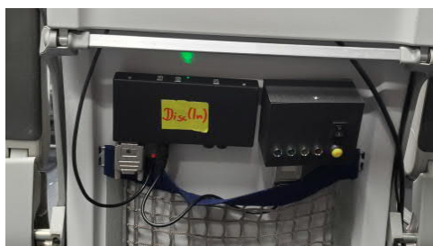
Abbildung 16: Diskretes Eingabemodul (links) und Ausgabemodul (rechts)
