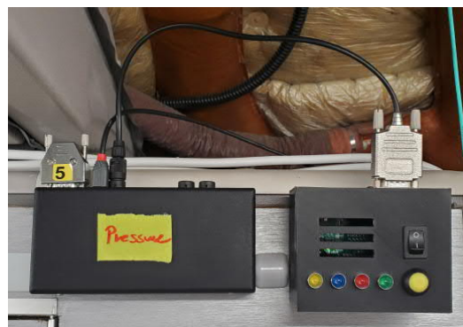
Abbildung 14: Beispiel eines Drucksensor (rechts) mit MTU (links)
