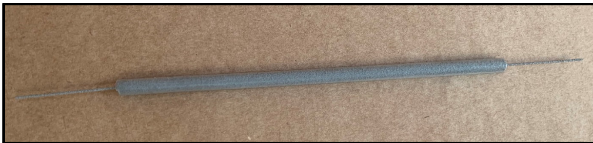
Abbildung 1.5 – Titanröhrchen mit PIN mit PFSA Membran beschichtet
