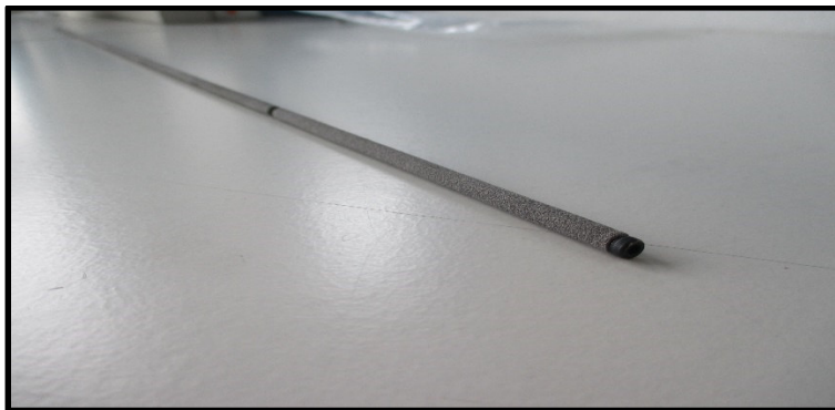
Abbildung 1.2 - auf Führungsstab aufgezogene Titanröhrchen
