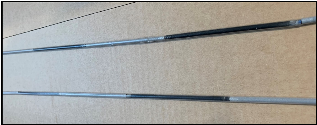
Abbildung 1.9 - Eloxiertes Titanröhrchen „STAR“ mit PFSA beschichtet
