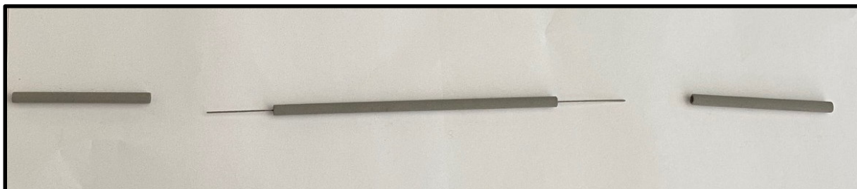
Abbildung 1.4 – Titanhohlkörper mit Pin und zugehörigen Konnektoren
