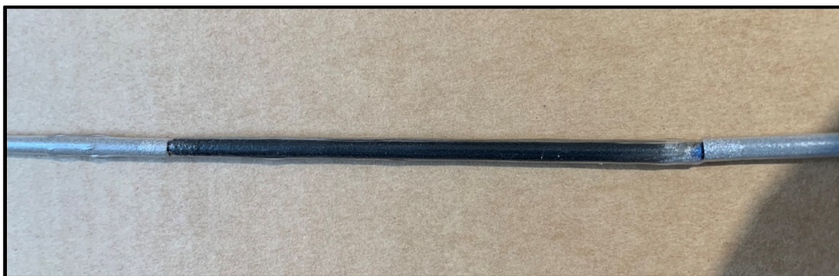
Abbildung 1.6 – Titanröhrchen (ROD, STAR) eloxiert mit PFSA Membran beschichtet
