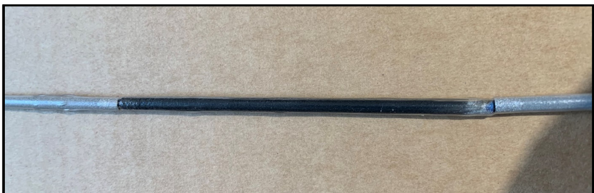
Abbildung 1.8 – Eloxiertes Titanröhrchen „ROD“ mit PFSA beschichtet
