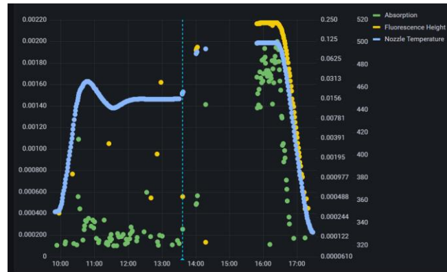
Abbildung 3: Temperatur, Fluoreszenz und Absorption des Atomofens werden in Echtzeit ausgewertet und können wie in der Abb. ersichtlich abgerufen werden.
