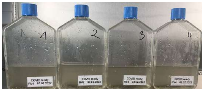
Abbildung II.17: Qualitätskontrolle- Realitätsnaher Laborvergleich mit gespiktem Abwasser. A) Positivenanteil zur Zeit der Nullprobenahme (Quelle: RKI-Dashboard). B) Erhaltene Proben, angekommen unter Einhaltung der Kühlkette am Beispiel KWR (NL)
