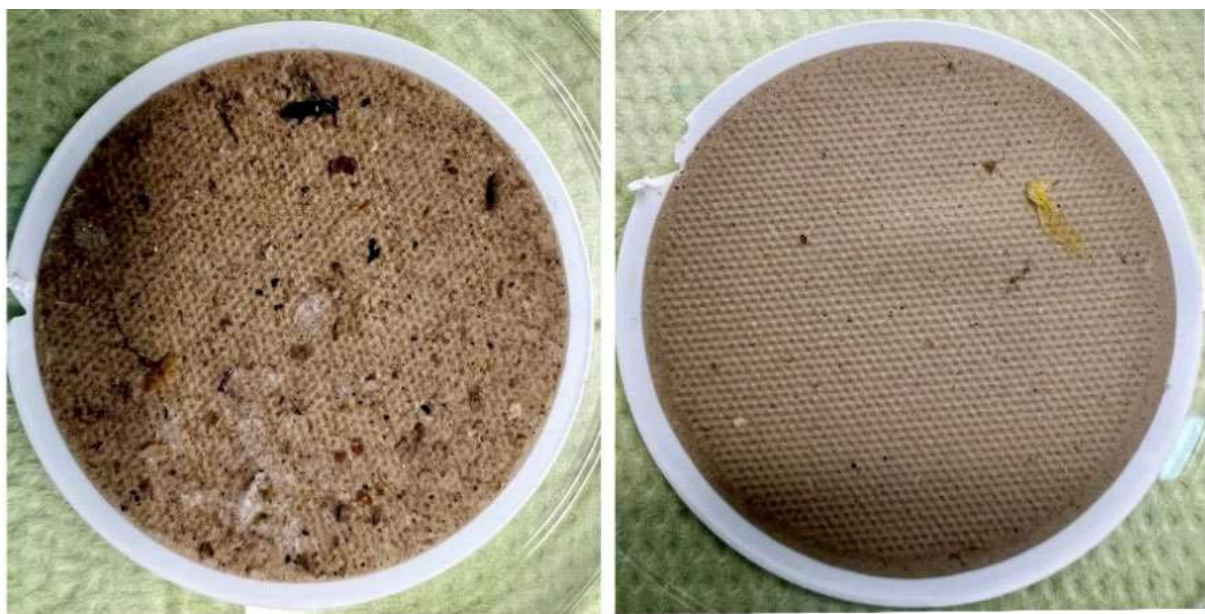
Abbildung II.6: Abwasserprobe über Membranfilter filtriert, links Homogenisiert durch Schütteln, rechts abgesetzt
