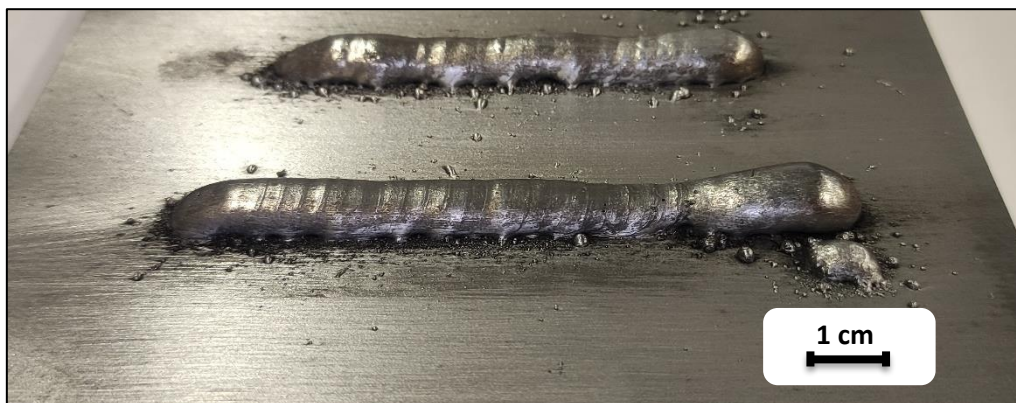
Abbildung 20: Erste Schweißparametersuche AluNanoCore
