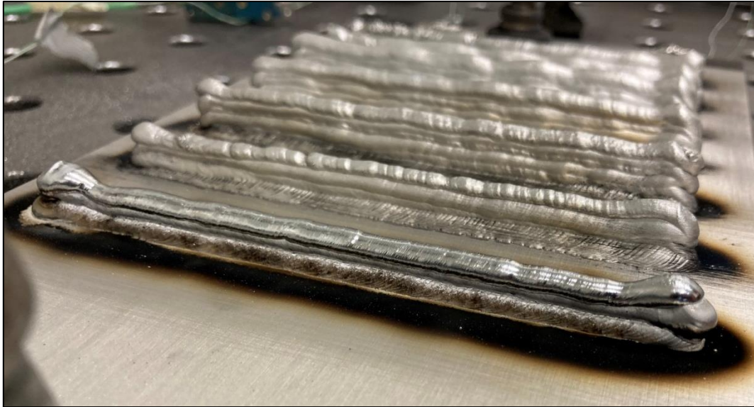
Abbildung 6: Evaluieren von Schweißparametern für mehrere Schweißraupen
