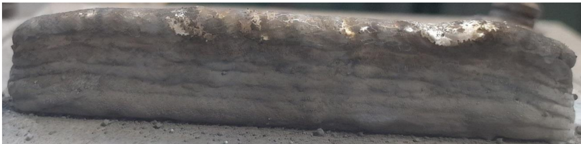
Abbildung 25: Mit Fülldraht additiv gefertigte Wand
