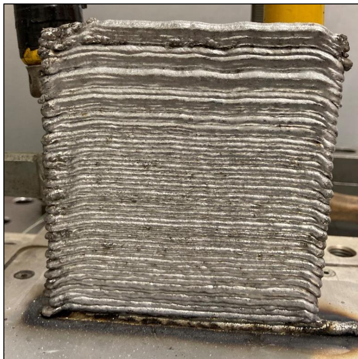
Abbildung 8: Schweißprobe mit einer Höhe von 109 mm
