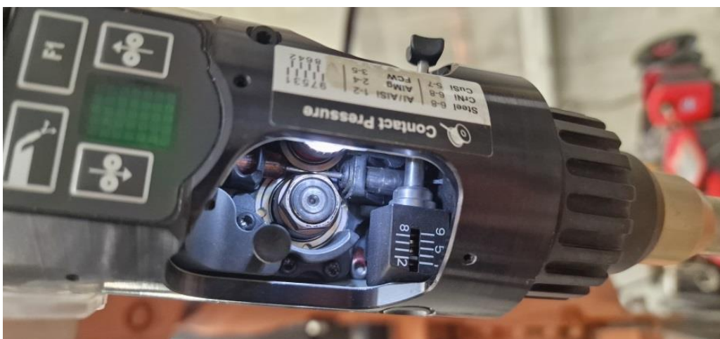
Abbildung 24: Fülldraht montiert am Schweißbrenner
