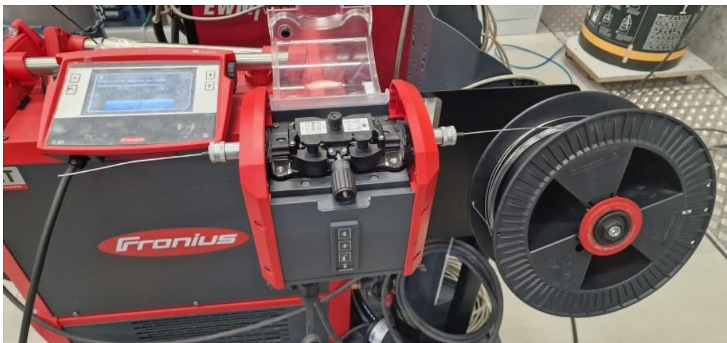
Abbildung 23: Fülldraht montiert an der Schweißmaschine
