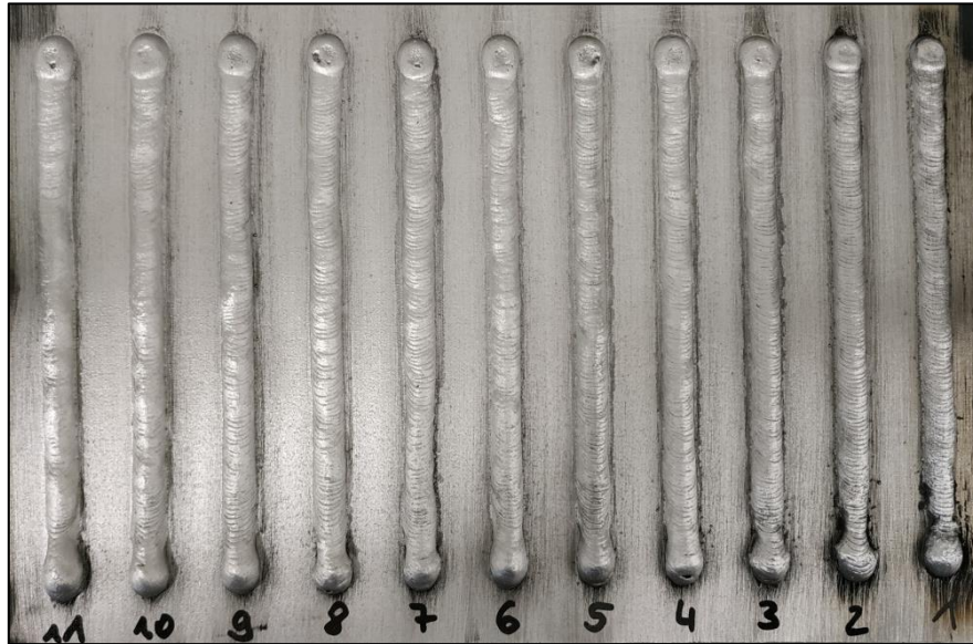
Abbildung 5: Evaluieren von Schweißparametern für die erste Schweißraupe
