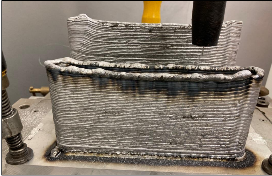
Abbildung 11: Schweißversuch mit dem Ziel die Breite der Schweißraupe zu erhöhen durch Erhöhung der Stromstärke
