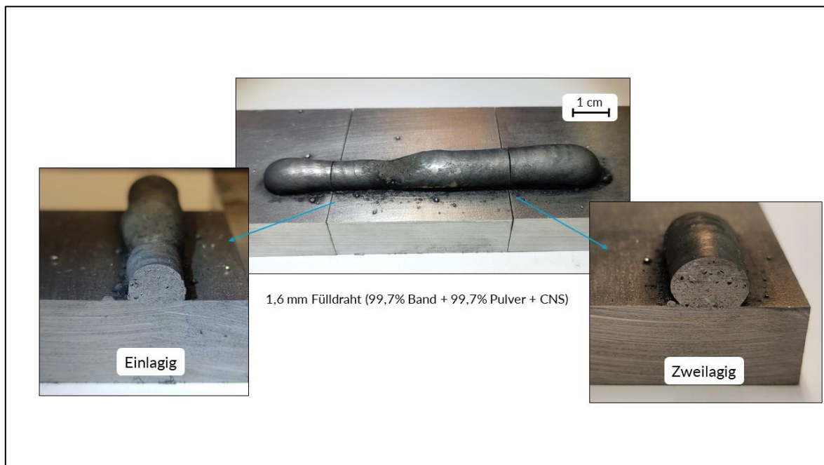
Abbildung 21: Visuelle Prüfung der Schweißnaht mit ANC
