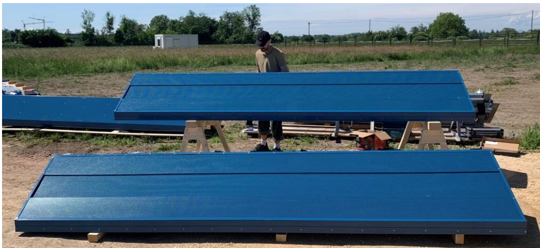
Abbildung 42: Fertige Kassetten bei der Endmontage der Solarmodule auf dem Testfeld
