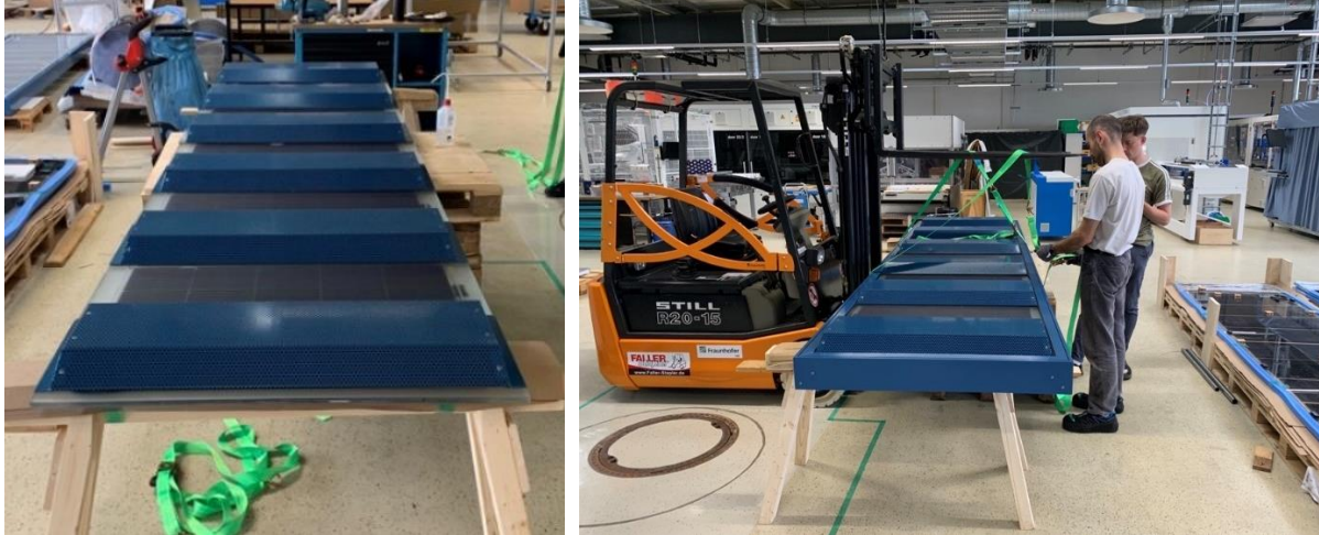
Abbildung 38: Kombinationslösung beim Zusammenbau von Modulen mit Absorberstreifen und Rahmen
