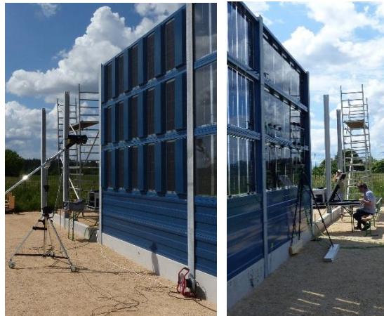
Abbildung 71: (links) Schematische Darstellung der Messung (Aufbau sowie Komponenten der Impulsantwort) des Luftschalldämmungsindex nach DIN EN 1793-6 an einer Lärmschutzwand (Bild: AED; [21]); (rechts) Messung am Segment (Vorder- und Rückseite) mit Kombinationslösung (Bild: BASt)
