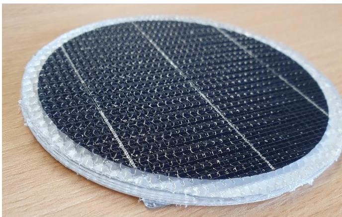
Abbildung 33: Beispiel Testmodul mit strukturierter Vorderseitenfolie
