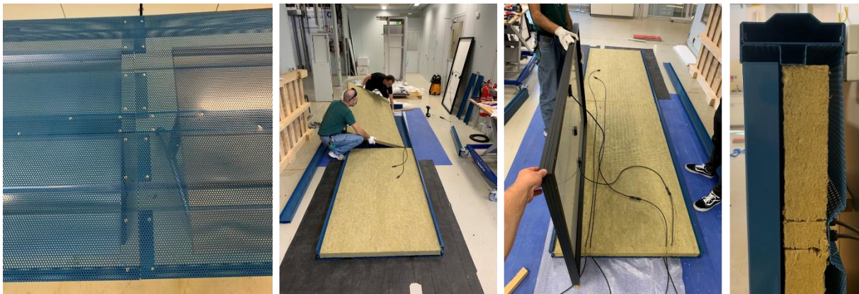
Abbildung 40: Zusammenbau der Bleche, Steinwolle, Seitenteile und Solarmodule von Konzept 8
