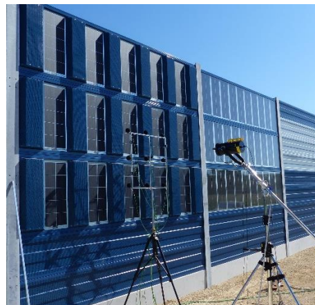
Abbildung 70: (links) Schematische Darstellung der Messung (Aufbau sowie Komponenten der Impulsantwort) des Schallreflexionsindex nach DIN EN 1793-5 an einer Lärmschutzwand (Bild: AED [21]; (rechts) Messung am Demonstrator-Segment mit Kombinationslösung (Bild: BAST)
