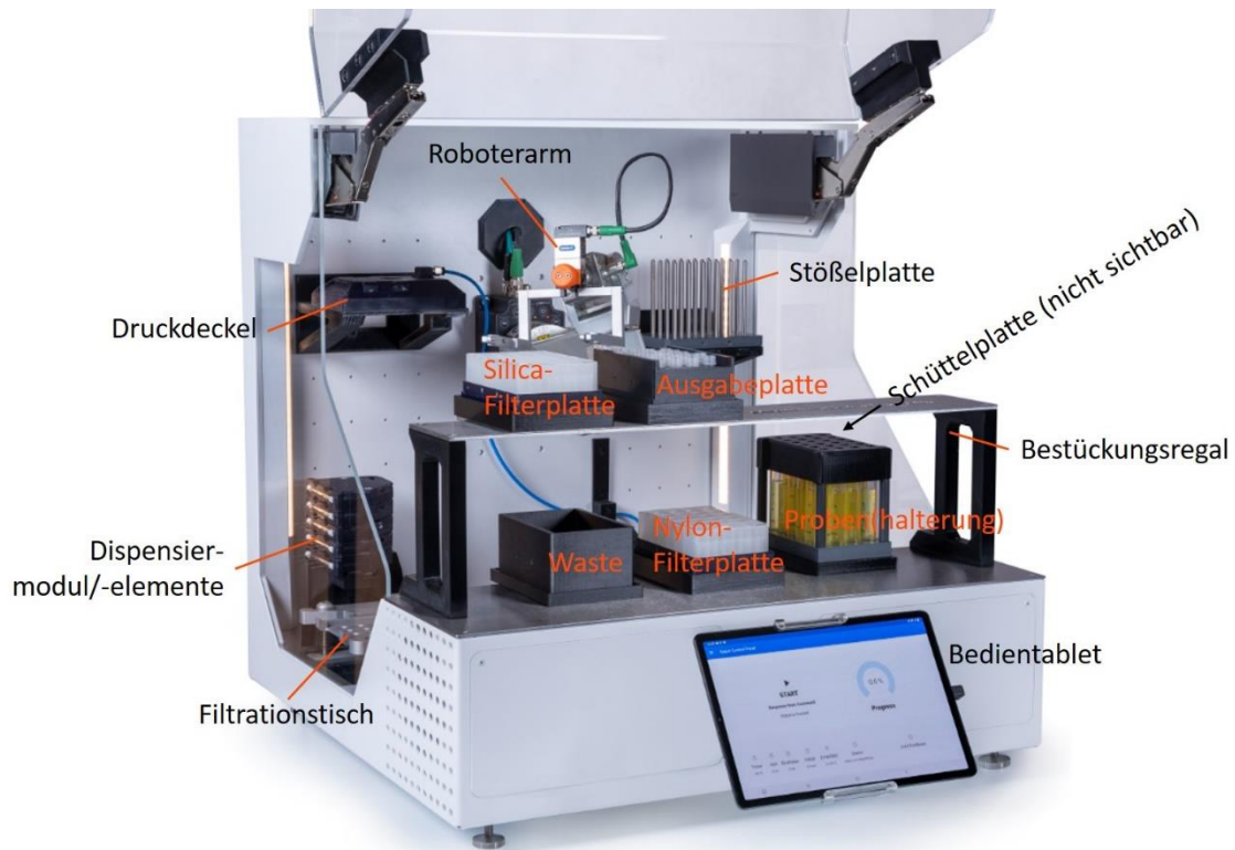
Abbildung 4: Bild des fertiggestellten Funktionsdemonstrator mit Beschriftung aller relevanten Elemente.
