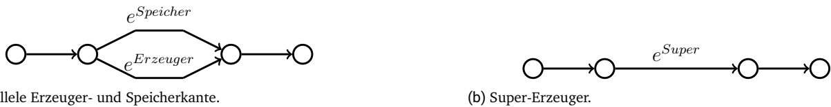
Abbildung 31: Aggregieren von Erzeuger- und Speicherkante zu einem Super-Erzeuger.
