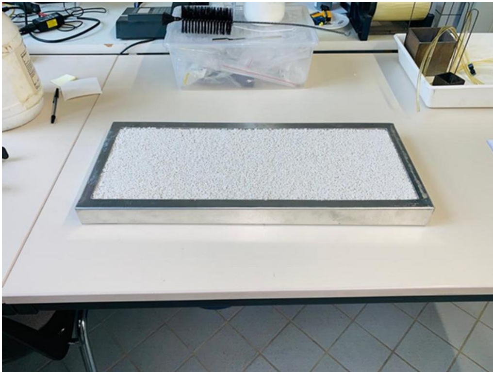
Abb. 5 Isolationsschicht aus Schaumglas-Hohlkugeln und Wasserglas als konfektioniertes Bauteil mit einer Schichtdicke von 20 mm
