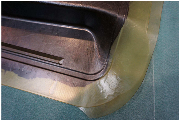
Abbildung 25: Falten in der Decklage des Bauteil außerhalb des relevanten Bereiches
