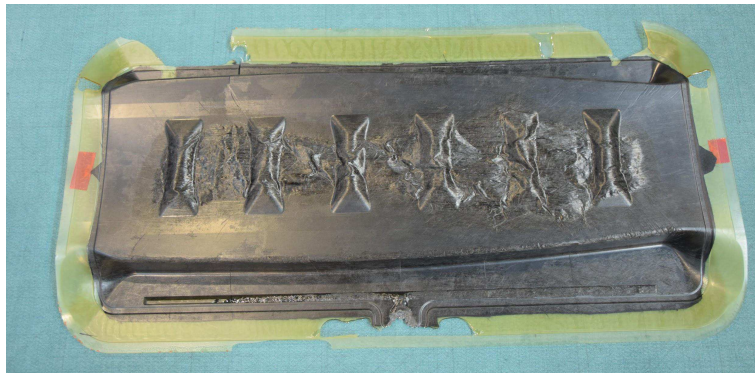
Abbildung 21: Fehlversuch der ersten rCF Rippe
