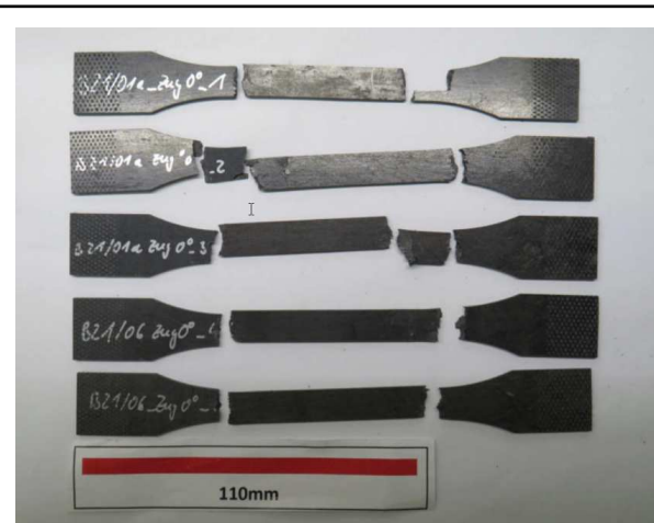
Abbildung 14: Zerstörte Zug-Prüfkörper hier am Beispiel B21/01a und B21/06
