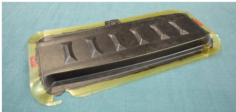
Abbildung 27: Bauteil mit \pm 45^\circ Faserorientierung
